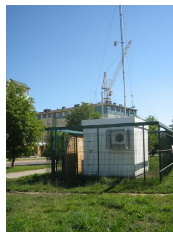
Fotografia X.3. Pomiary imisji z wykorzystaniem mobilnego laboratorium i automatycznej stacji zanieczyszczeń powietrza
