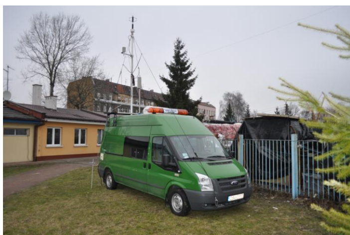
Fotografia X.3. Pomiary imisji z wykorzystaniem mobilnego laboratorium i automatycznej stacji zanieczyszczeń powietrza
